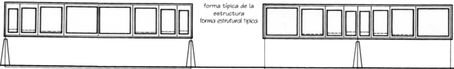
De acuerdo con la distribución de los esfuerzos cortantes de una viga, la sollicitación a flexión en los montantes es muy desigual. La diferencia puede evitarse disminuyendo la luz de los vanos hacia los apoyos o ampliando la anchura de los montantes.
