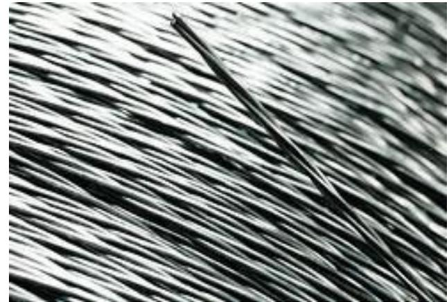
Existen básicamente dos métodos para el estiramiento de estas armaduras llamadas activas y la consecuente precompresión del H°. Estos difieren fundamentalmente en el momento en que se produce el tesado de los cables. **Estructuras pretesadas** serán aquellas donde se tesa antes de hormigonar, y **estructuras postesadas** las que se lo hace con el hormigón endurecido.
