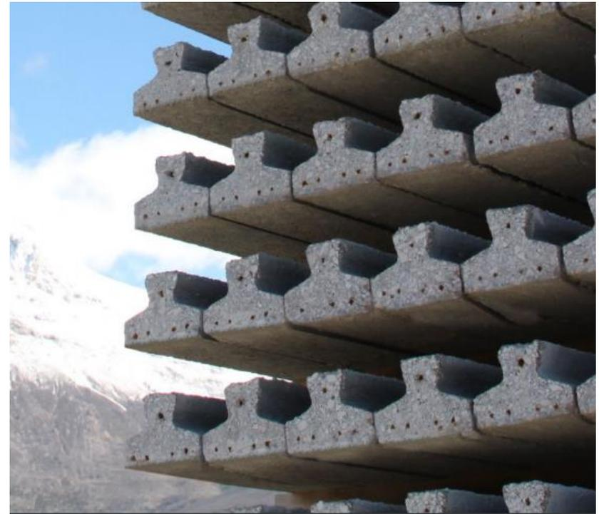
Hormigonado de Viguetas pretensadas
