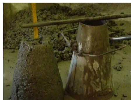
Figura 4: Ensayo de asentamiento, a) molde troncocónico (cono de Abrams), b) compactación en capas y c) medición del asentamiento.
