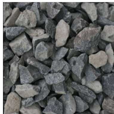
Figura 3: Tipos de agregados gruesos: a) canto rodado y b) piedra partida.
