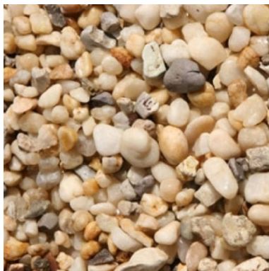
Figura 3: Tipos de agregados gruesos: a) canto rodado y b) piedra partida.
