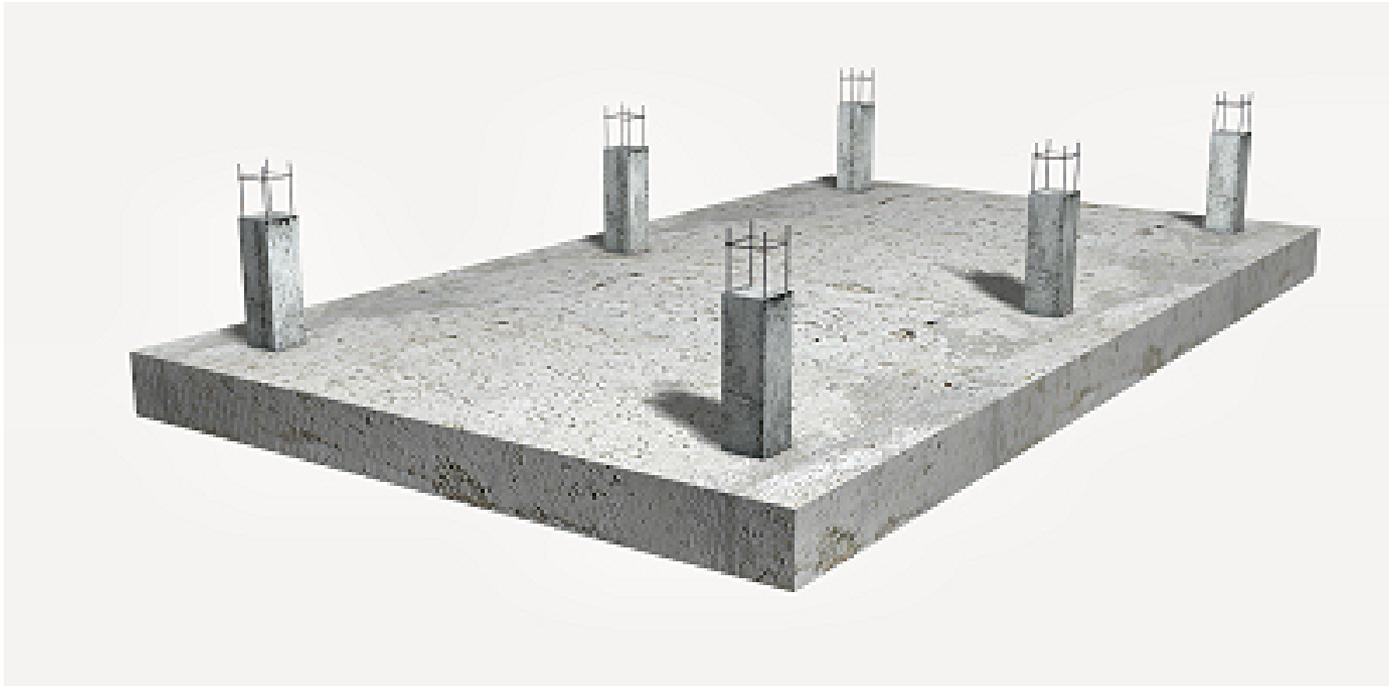
**Definición:** Una **Platea** es una losa de Hormigón armado apoyada sobre el terreno. La misma reparte las cargas de la edificación sobre toda la superficie de apoyo.
